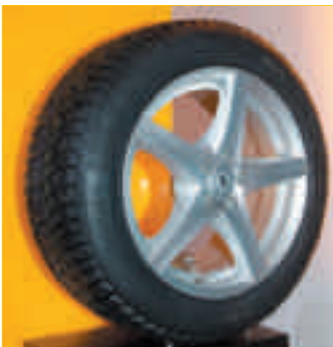
◆ Conti Ice Contact 2 kommer som SSR-däck (run flat till vänster) till BMW och Mercedes. Samtidigt kommer däckets också som ett seal-däck (till höger).
