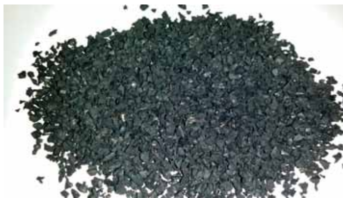
Rivet gummipulver "granulat", från personbils- och lastbilsdäck i asfaltmassan minskar risken för sprickor i vägbeläggningen. (Foto: Leif Viman).
