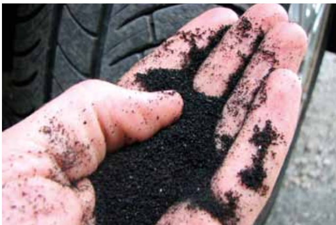
Klippta däckchips, 5-20 cm stora kan bli undermedlet för enskild avloppsrening. (Foto: Ragn Sells).
