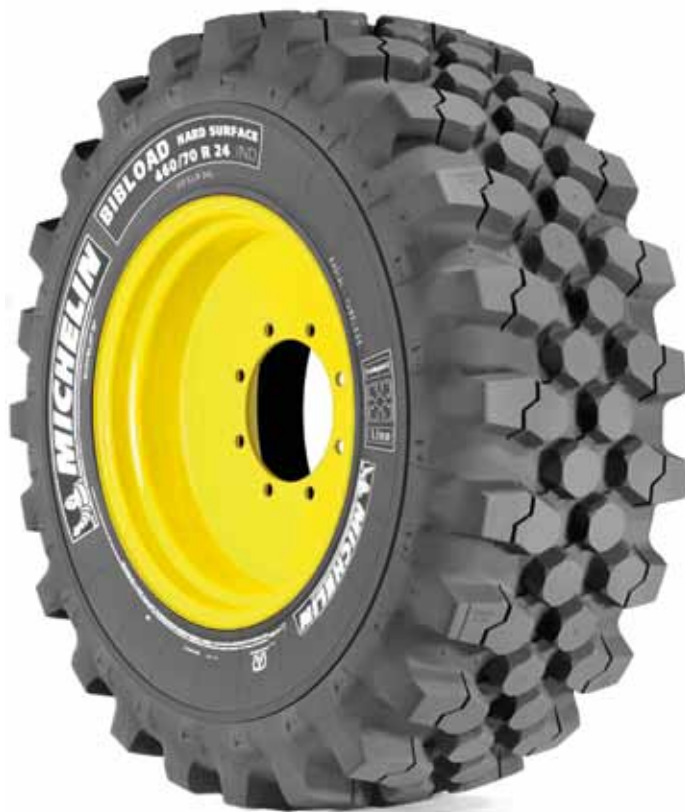
Däcket har ett nytt patenterat mönster med diamantformade klackar. Varje diamantformat block har sex kanter och 12 olika riktningar.
