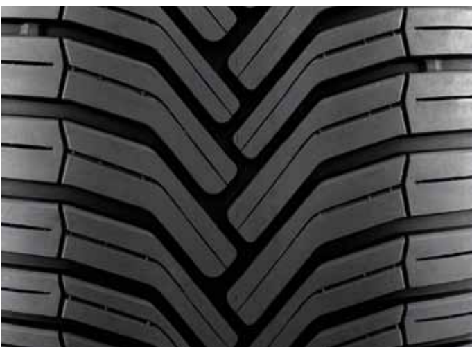
Tre olika tekniker har använts för att utveckla slitbanan. Ett är det V-formade mönstret med 3D lameller som är vägformade med olika tjocklekar.
