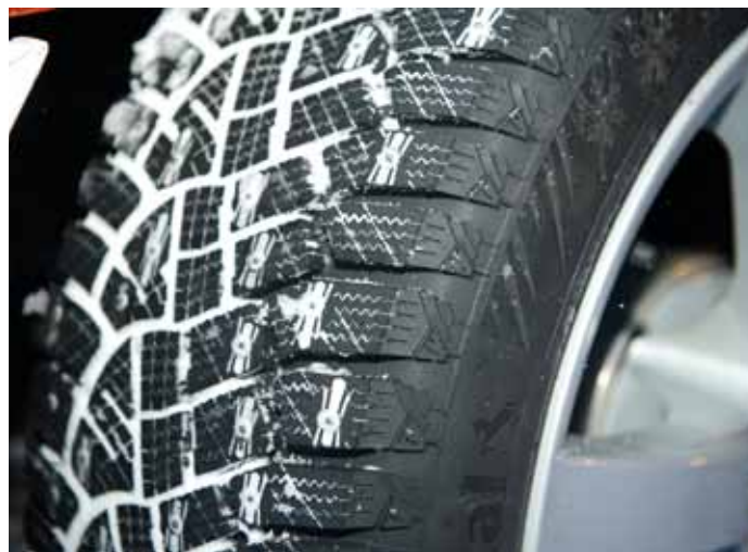
Det nya mönstret är asymmetriskt och har sajpningsform på utsidan som gynnar kurvgreppet, på insidan sajpnings som ger bra broms- och drivgrepp. Notera spåren runt dubbarna där iskross samlas och slungas ut för att behålla dubbutsticket.
