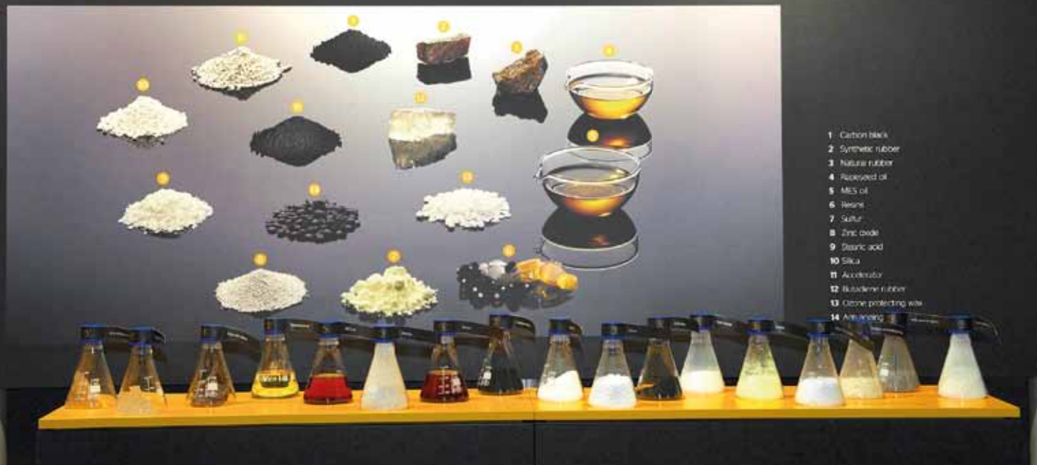
Ingredienserna i ett vinterdäcksrecept är fler än i många kulinarisk anrättning. Kimrök (carbon black), silica, syntetgummi, Butadiene-gummi (skyddar mot olja och bensin), naturgummi, rapsolja, harts, svavel, zinkoxid, ozonskyddsvax, mm, mm.
