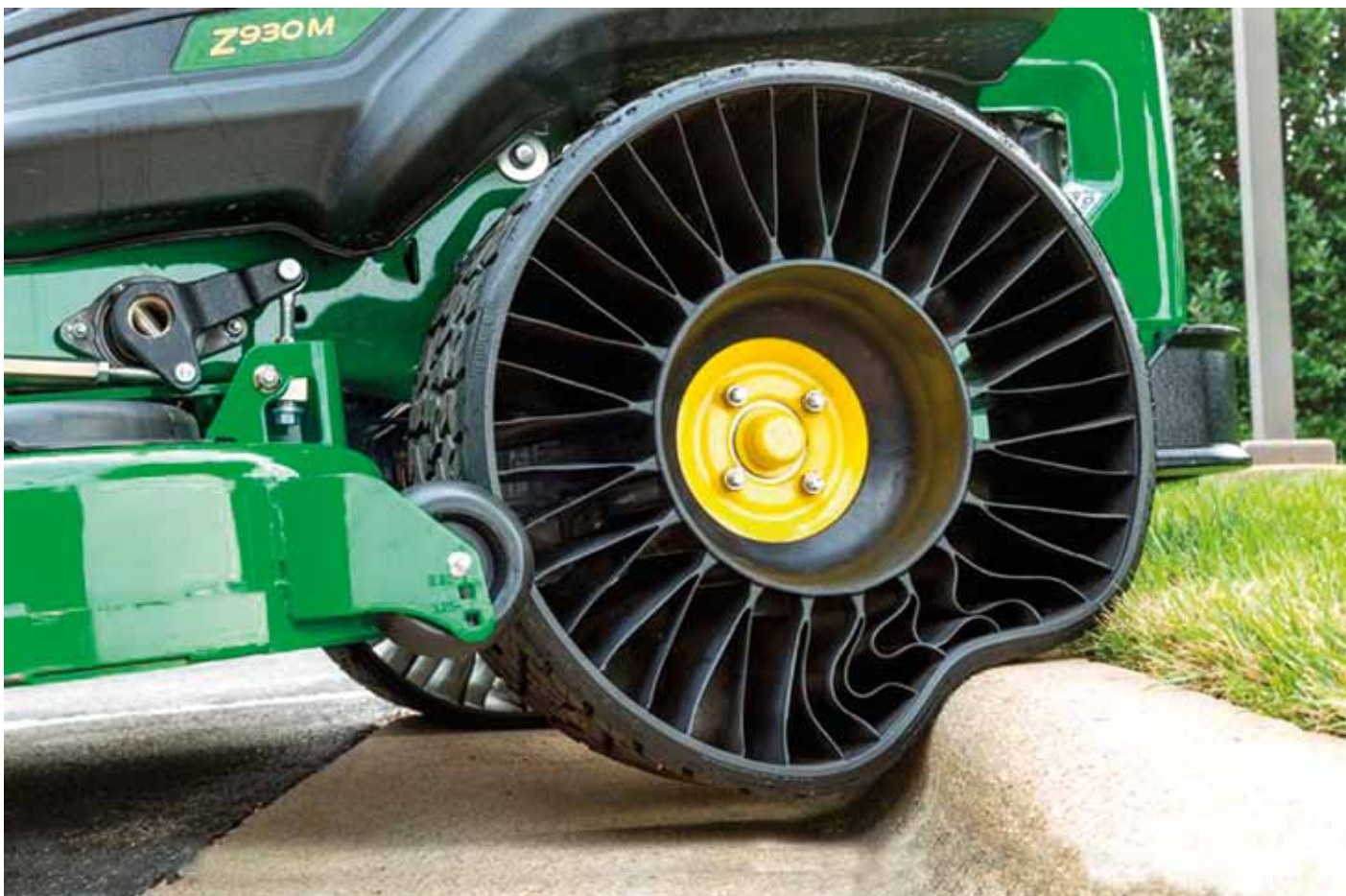
De mjuka flexibla ekrarna anpassar sig till underlaget utan att det uppstår någon punktering eller skada på däcket.
