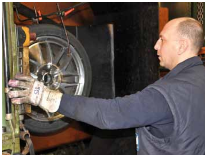
Den som utförde testerna hos TÜW Nord var Frank Skibbe som här placerar ett av däcken i testtunnan. Däcket körs i en timme upp till däckets topphastighet. Det som mäts är också däckets loadindex.
