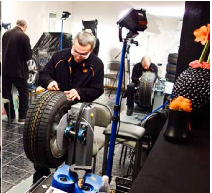
Vår grupps sajpningsförslag ritas in på däckets klackar. Bara det är ett tidsödande jobb, och sen ska mönstret skäras in också...
