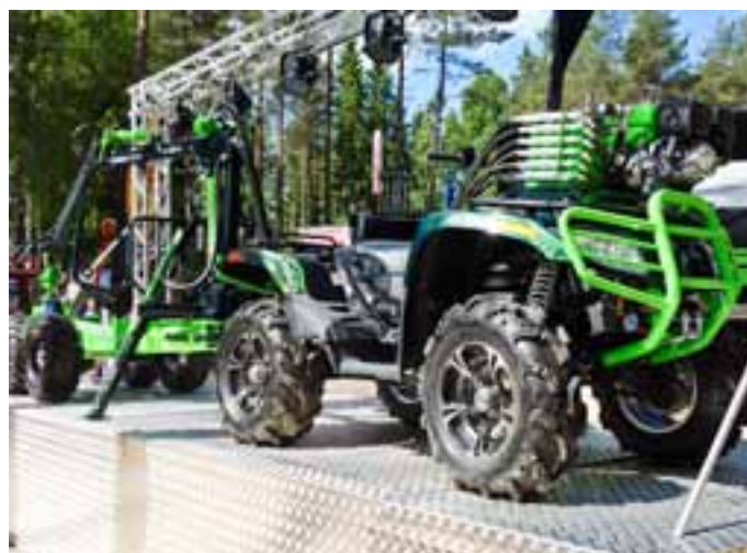
Kranman har utvecklat världens snabbaste skogsekipage. T1900e har 150 hk, driver på alla åtta och bygger på Arctic Cat MUD PRO 1 000.
