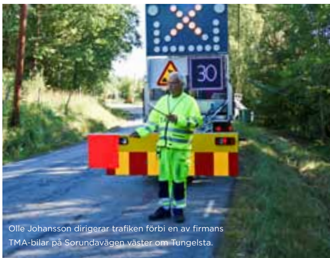
Den nedfällbara ”krockkudden” bak på en TMA-bil kan – beroende på utförande – fånga upp bilar på upp till 3,5 ton i farter upp till 90-100 km/h utan att de åkande skadas allvarligt – om de är bältade.
