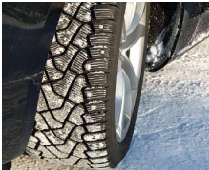
Pirellis nya dubbdäck Ice Zero har en ny patenterad dubbteknik kallad "Dual Stud", alltså dubbeldubb, som uppges ge samma effekt som två vanliga dubbar.
