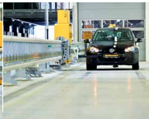
Katapulten klar, en styrarm i fronten säkrar riktningen.
