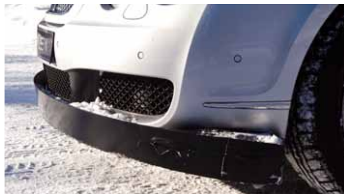
Inte så snygga, men de låga extra stötfångarna skyddar effektivt bilarna från småskador vid snövaltskontakt.
