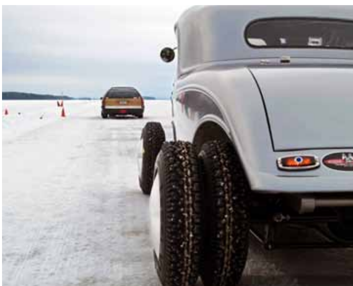
På sommaren är det vanlig dragracing som gäller för Gustav Abramssons Ford -34:a Coupé. På vintern behövs dubbelmontage för att få ner kraften.
