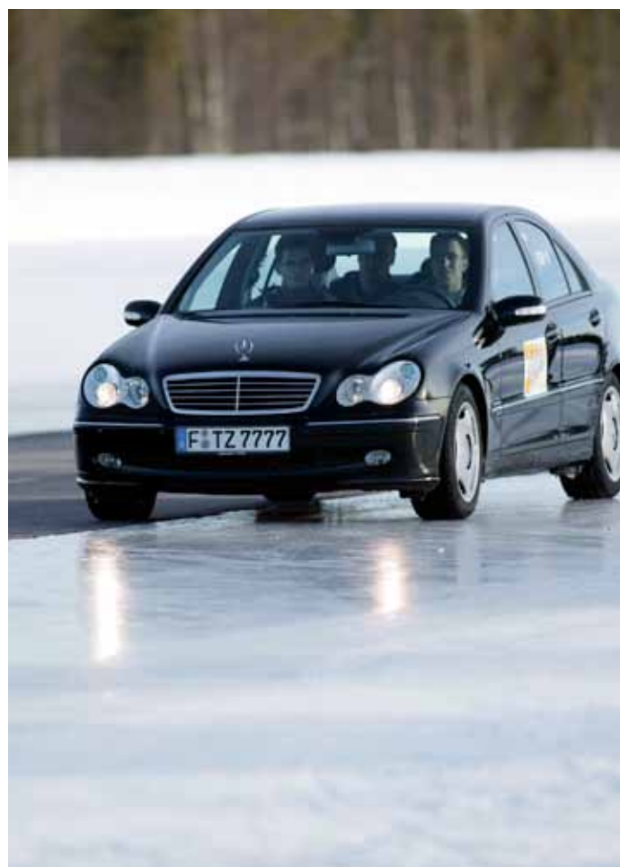
Vid så kallat split friction-test körs bilen, här en Mercedes C-klass, med ena hjulparet på asfalt och det andra på halt underlag.
