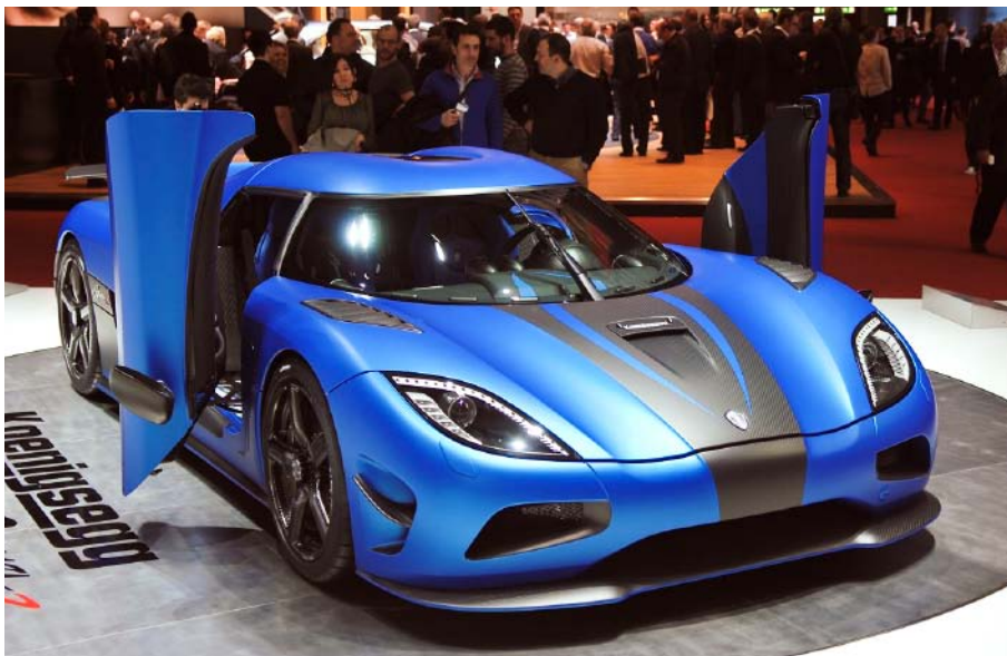
Koenigsegg, som ju numera är vårt enda svenska "personbilmärke", visade upp nya Agera R med 1140 hk, världens första ihåliga kolfiberfälgar (sparar 20 kg) och trendig "mattmetalliclack".
