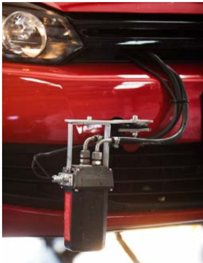
Bränsleförbrukning mäts med utrustning monterad direkt på bilen.
