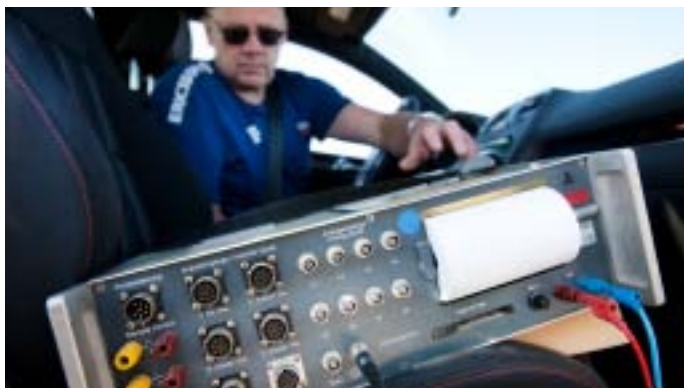
All data loggas under alla testmoment, utom vid vissa helt subjektiva körningar. Dessutom kontrolleras temperatur, vindstyrka och luftfuktighet regelbundet.
