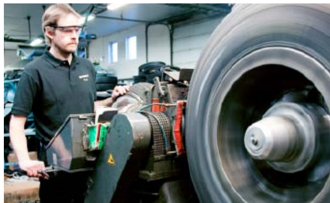
Ett uttjänat däck kratsas hos JS Retreading för att få ett nytt liv.
