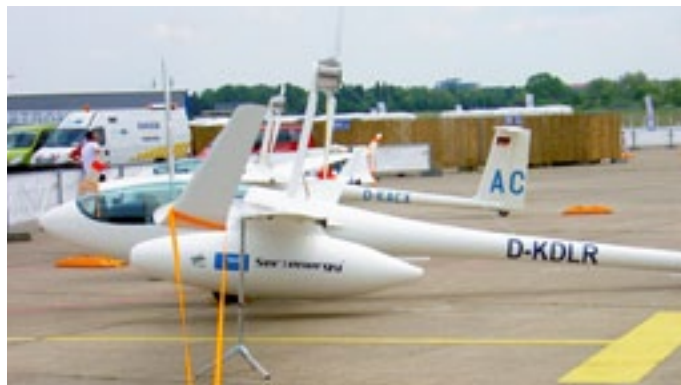
Antares DLR-H2 är världens första bemannade flygplan som drivs av bränsleceller. Maxeffekt 57 hk, toppfart ca 170 km/h och räckvidd 75 mil. Tomvikt 460 kg och maxlast 290 kg.
