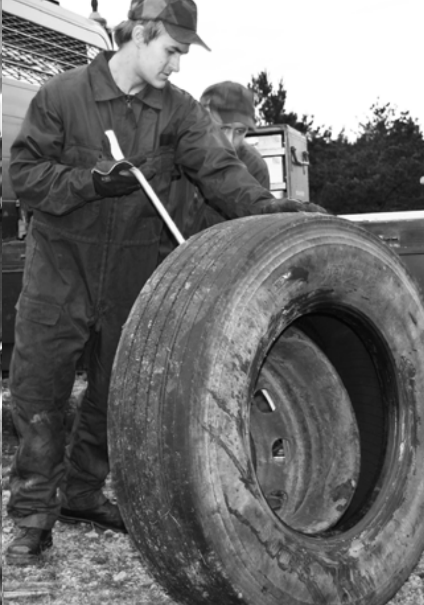
Under utbildningen i Sverige får gummimekaniker som ska ingå i reparationsplutoner även lära sig gammal reparationsteknik för att med manuella metoder kunna klara en reparation framme i stridslinjen när det inte finns maskiner tillgängliga.
