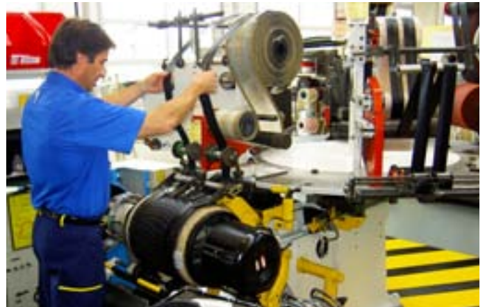
Mindre volymer, som udda dimensioner, racingdäck samt tunnelbane- och spårvagnsdäck görs mer eller mindre för hand
