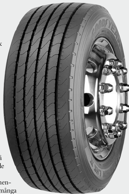
Marathon LHS II, som finns i två dimensioner, är det första styrdäcket någonsin som kombinerar en tryckkapacitet på åtta ton på framaxeln.
