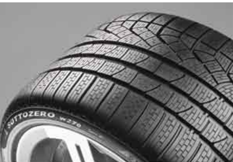
Däcken har ett asymmetriskt mönster med ett blockmönster utvecklat för att klara våta vägbanor samt snö och slask.
