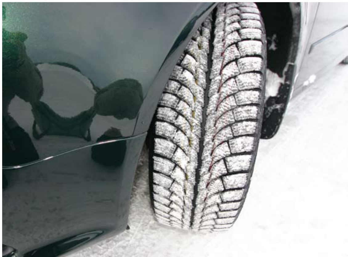
Det nya SoftFrost 3 har ett stort antal blockkanter och snöfickor som ger ett större antal greppkanter där snö kan samlas och öka friktionen mellan snö och snö.
