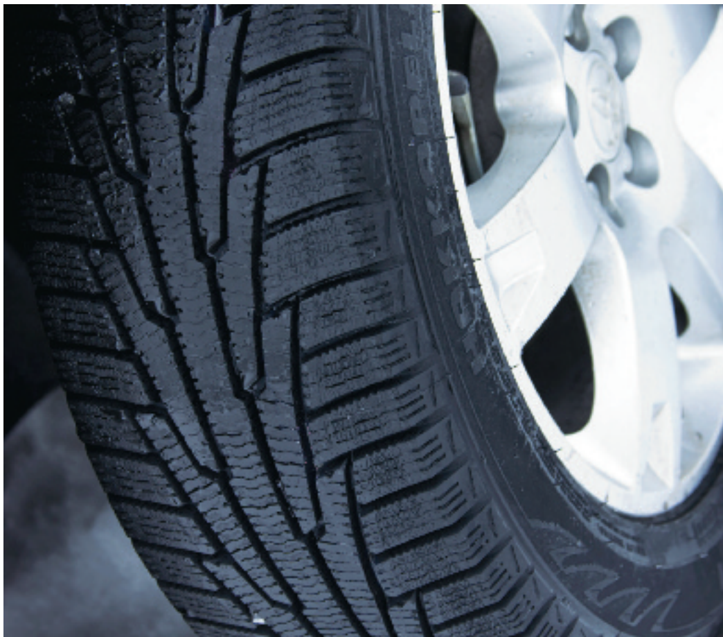
Nokia satsar nu på odubbade däck. Bilden visar Hakkapeliitta R. Nytt är att skuldrornas klackar är försedda med 860 små pumplameller som suger upp och sedan sprutar undan den tunna vattenfilmen. Det nya däck- et finns också som SUV-däck.
