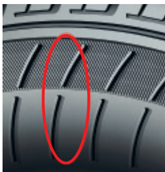
Den nya tekniken använder luftvirvlar som skapas på utskjutande delar på ytan av däckets sidovägg.
