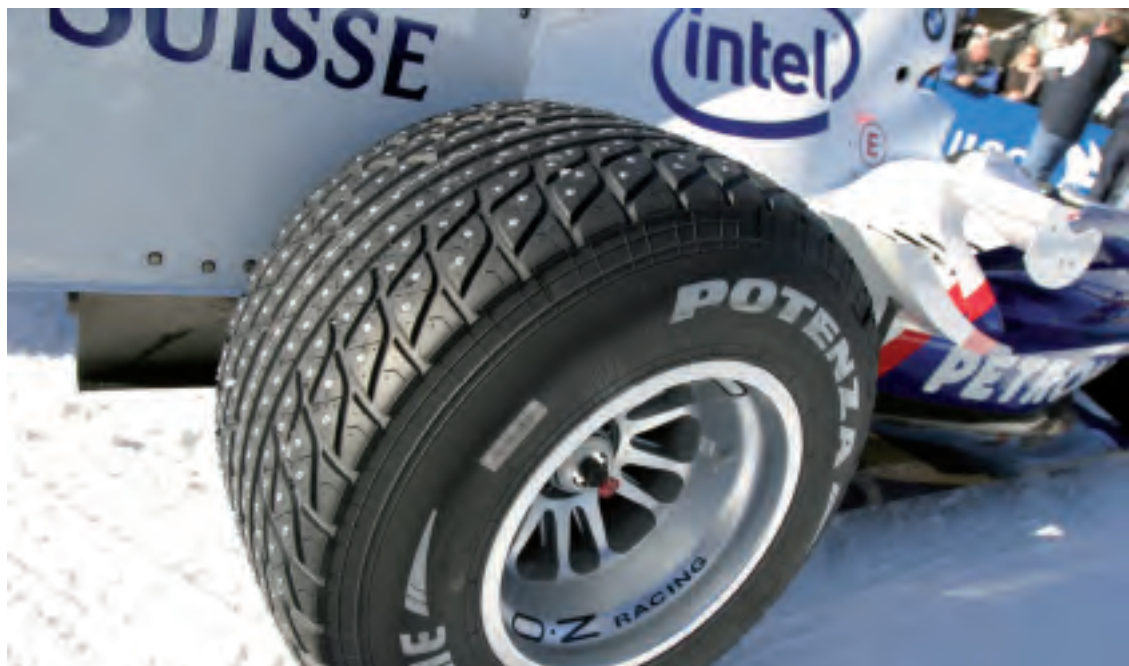
Ett särskilt vinterdäck med dubb tillverkat av Bridgestone gjorde det möjligt för BMW Saubers F1-team att köra ett demonstrationslopp ute på en sjö i St. Moritz
