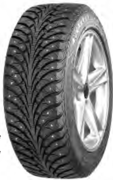
Dubben i slitbanan är placerade symmetriskt. Det skapar fler parallella spår och ger ett bättre grepp.
