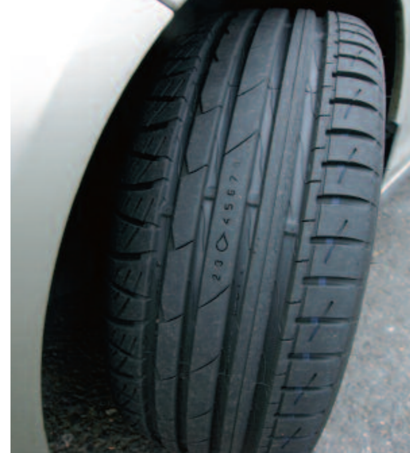
På det nya däck finns en vattenplaningsvarnare. Den anger hur många millimeter som är kvar av mönsterdjupet. Vid fyra millimeter försvinner den helt.
